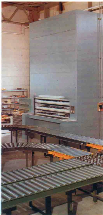
استفاده از نقاله غلتکی در یک سیستم نیمه مکانیزه
