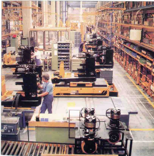
استفاده از سیستم خود جریان در یک خط تولید نیمه مکانیزه رباتیک
