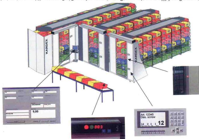
دستگاه نگهداری چرخان افقی همراه با سیستم‌های کنترلی و نرم‌افزاری آن
