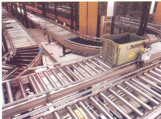
استفاده از نقاله‌های غلتکی ثقلی در انبارهای تمام مکانیزه
