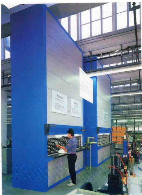
یک سیستم نگهداری چرخان عمودی در حال کار
