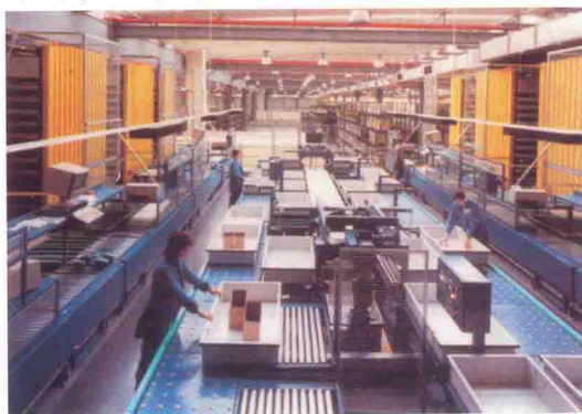
استفاده از نقاله‌ها در ورودی و خروجی یک AS/RS
