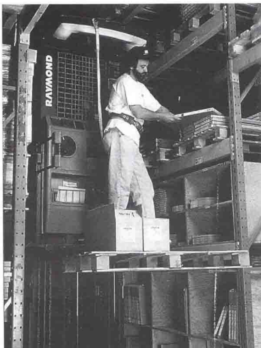
عکس (۱): ادغام سه انبار در یک انبار و افزایش ظرفیت نگهداری به میزان ۶۷ درصد با استفاده از سیستم راکر-راهرو پارک و تجهیزات چابک جایی به خصوص سفارش چینی.
