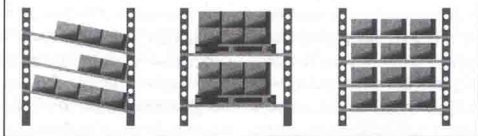
سه نوع مختلف از تجهیزات نگهداری انباری / دسته چینی کالا که برای تواتر و روش برداشت ضروری به منظور حذف کلوکها و رفع نیازهای خرده فروشی ها به صورت بهنگام، مناسب می باشد.
