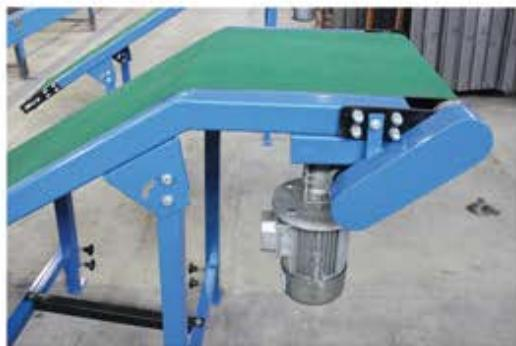
بستراین نقاله ها تسمه است که معمولاً برروی غلتک های هرگزد توسط موتور گیربکس مناسبی به حرکت در می آیند. این سیستم دارای یک سطح حمل تخت و صاف بوده که به راحتی می تواند کالاهایی با شکلهای نامنظم رانیز جابجا نماید. جنس، شکل و ضخامت تسمه ها دارای تنوع بسیار زیادی است که بسته به نوع محصول و محیط کار و شرایط روحی، بهترین گزینه مشخص می گردد. معمولاً در سطح افقی و یا شیب کمتر از ۲۰ درجه از تسمه ساده و برای شیب های تا ۳۵ درجه از تسمه های آجدار و برای شیب های تندتر، از تسمه های باله دار استفاده می شود.
