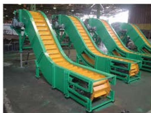
بستراین نقاله ها صفحاتی از جنس فلز- چوب و یا مواد پلیمری می باشند که برروی زنجیرهای مخصوصی متصل شده و توسط موتور گیربکس مناسب به حرکت در می آیند.
