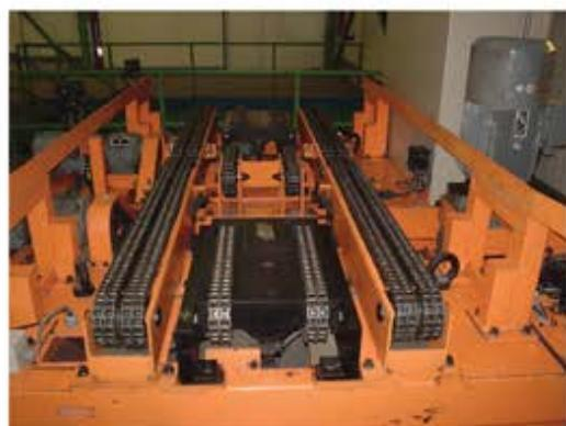
بستراین نقاله ها از دو یا چند ردیف زنجیر تشکیل شده که خود این زنجیرها می توانند یک یا چند ردیفه باشند. که بسته به نوع و وزن کالا، طراحی و ساخته می شوند. این نقاله ها عموماً جهت حمل بارهای سنگین، حجمیم و صلب استفاده گردیده و معمولاً کالاهای در جعبه، باکس پالت و یا روی پالت چیده شده و توسط این سیستم منتقل می شوند.
